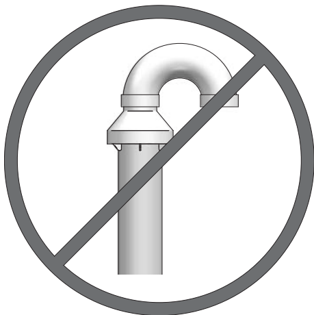
Figure 4-5 N'installez pas de coude en U sur le bouchon de pluie
